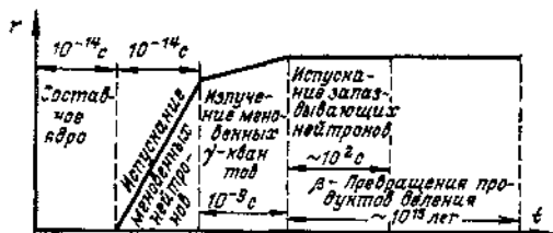
Рис 34. Схематическое изображение стадий процесса деления ( r — расстояние между образовавшимися ядрами, t — время протекания стадий. Перемещение осколков деления условно изображено в виде прямых линий)
